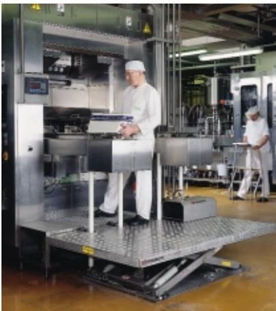
Las dos fotos de abajo muestran a un hombre muy alto y a otro de estatura mediana junto a la misma máquina. La gran diferencia en la altura de la plataforma muestra con claridad cuánto hay que modificar la altura para ofrecer a cada uno de ellos la posición de trabajo ideal.
