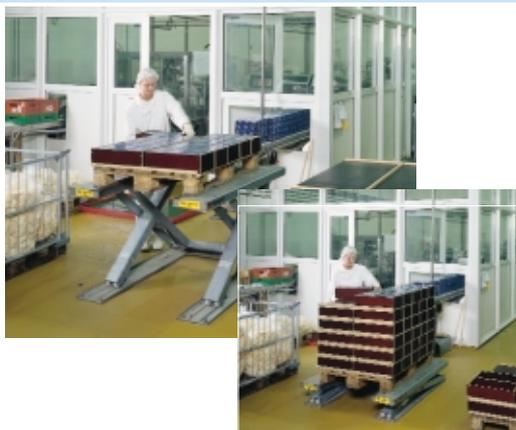
La foto sobre estas líneas muestra una mesa elevadora galvanizada al horno, en forma de U, en la sala de empaquetado de una central lechera. La simple adaptación de altura permite que el operario trabaje permanentemente a la altura ideal al pasar los paquetes de la cinta al palet. Una vez lleno el palet, éste se retira fácilmente con una transpaleta normal.
