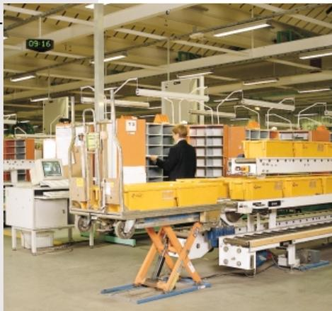
Una solución flexible, rápida y simple, dado que la mesa elevadora no precisa ser instalada en un foso.
