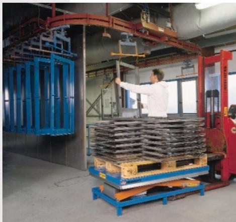
Un clásico ejemplo en la industria de la madera. Se coge una pieza del palet, se mecaniza y pasa a otro palet. Con una mesa en ambos lados, el operario puede trabajar a una altura confortable, aumentando la eficacia en un 20-30%.
