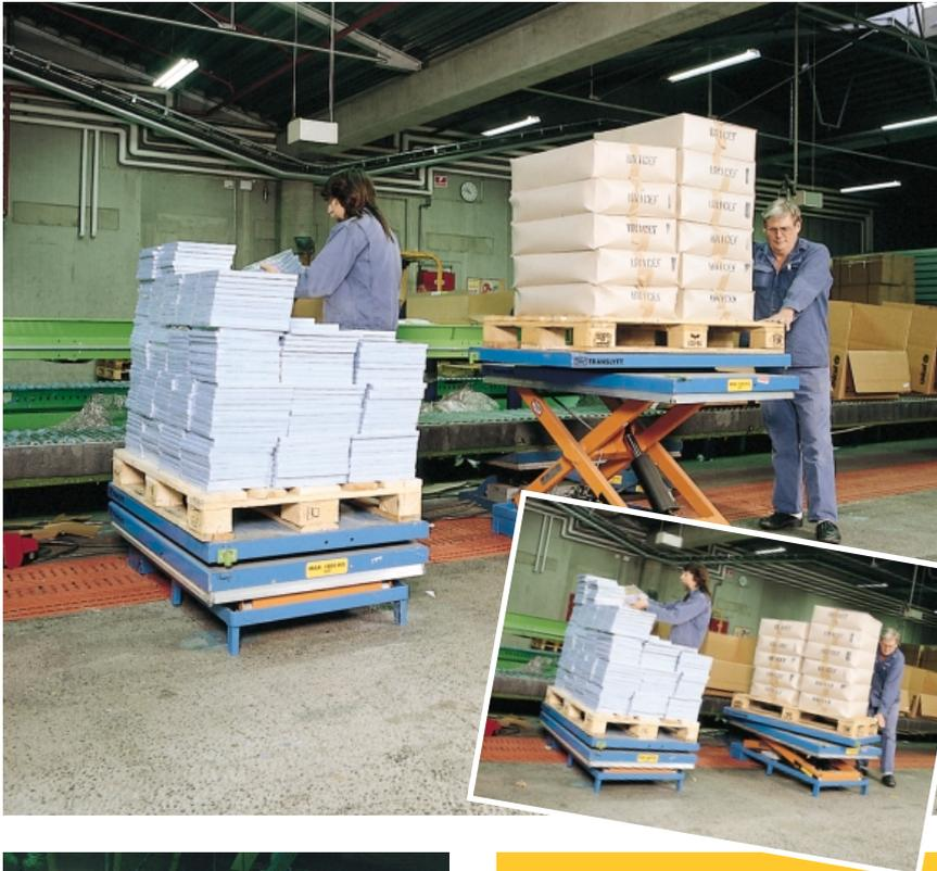
Una plataforma giratoria puede mejorar las condiciones de trabajo en la carga y descarga de palets.
