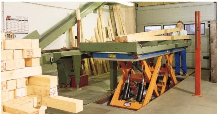
Las mesas de gran longitud se usan a menudo en aserraderos. En la foto vemos una mesa para elevar una carretilla con vigas largas. El poste situado a la derecha es una fotocélula que ajusta automáticamente la altura de la carga.
