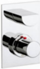
03 Mezclador termostático empotrable de 1/2" - 1/2" para baño-ducha (40 l/min) con desviador-regulador de caudal a las dos salidas superiores. Dispone de una salida inferior libre (según tipo de instalación deberá utilizarse una llave de paso).
