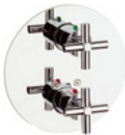
01 Mezclador termostático empotrable de 1/2" - 1/2" para baño o ducha (30 l/min) con llave de cierre incorporada a salida ducha y libre salida baño (según tipo de instalación deberá colocarse una llave de paso).
